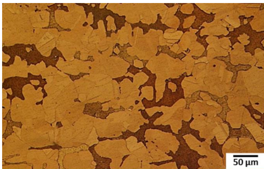
شکل ۳ ریزساختار نمونه اولیه، آنیل شده در دمای ۵۰۰ درجه سانتی‌گراد
