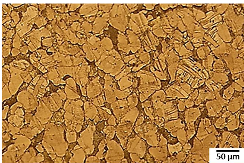
شکل ۵ ریزساختار نمونه پاس دوم پس از فرآیند ECAP در دمای ۳۵۰ درجه سانتی‌گراد در مسیر C
